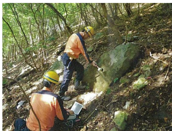
図 4-2 斜面における転石の振動計測状況
