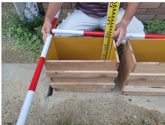
図 4-5 模擬剛体の作成に必要なコンパネ製型枠
