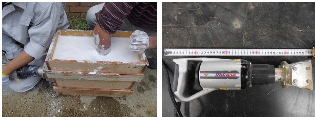
図 4-7 模擬剛体作成時の攪拌状況
